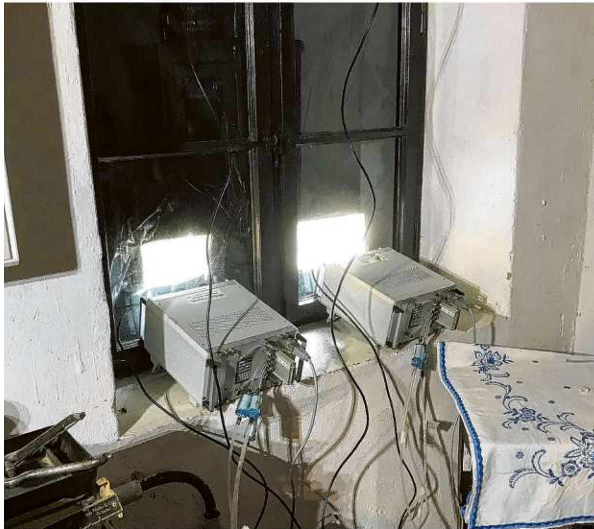
Mit Messgeräten im Inneren wird die Gaskonzentration kontrolliert und protokolliert.
